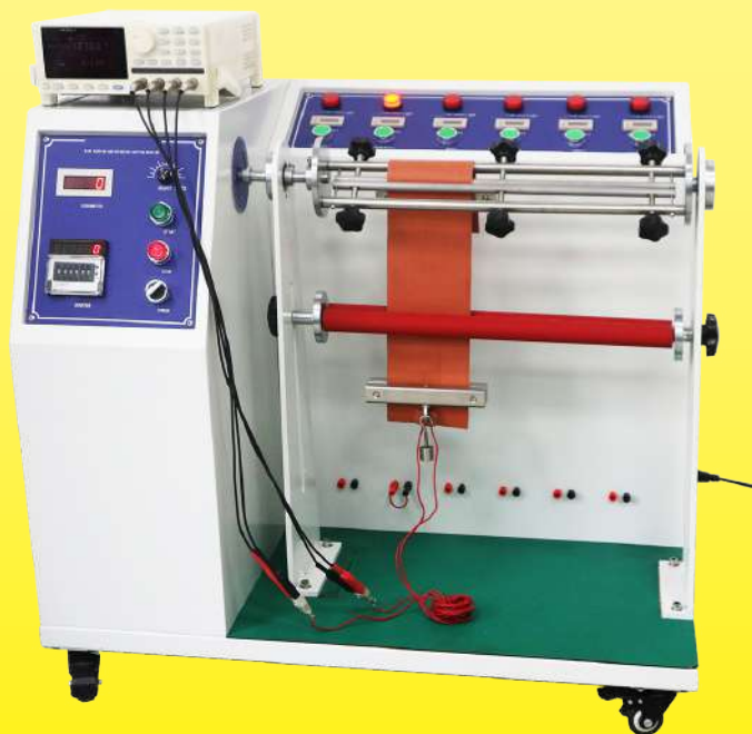
Flexible Silikonheizung während des Biegetests
