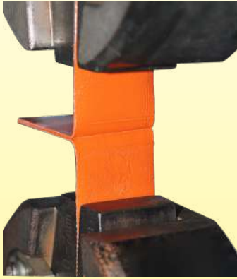
Vulkanisierte Probe vor der Ablösungsprüfung
